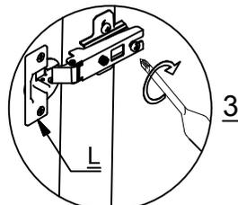
3. FRONT-TO-BACK BY THE HINGE ARM MOUNTING SCREW
