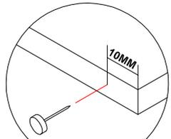
**WARNING : THE FRONT NAIL LEG MUST FIX AT 10MM FROM FRONT.**
