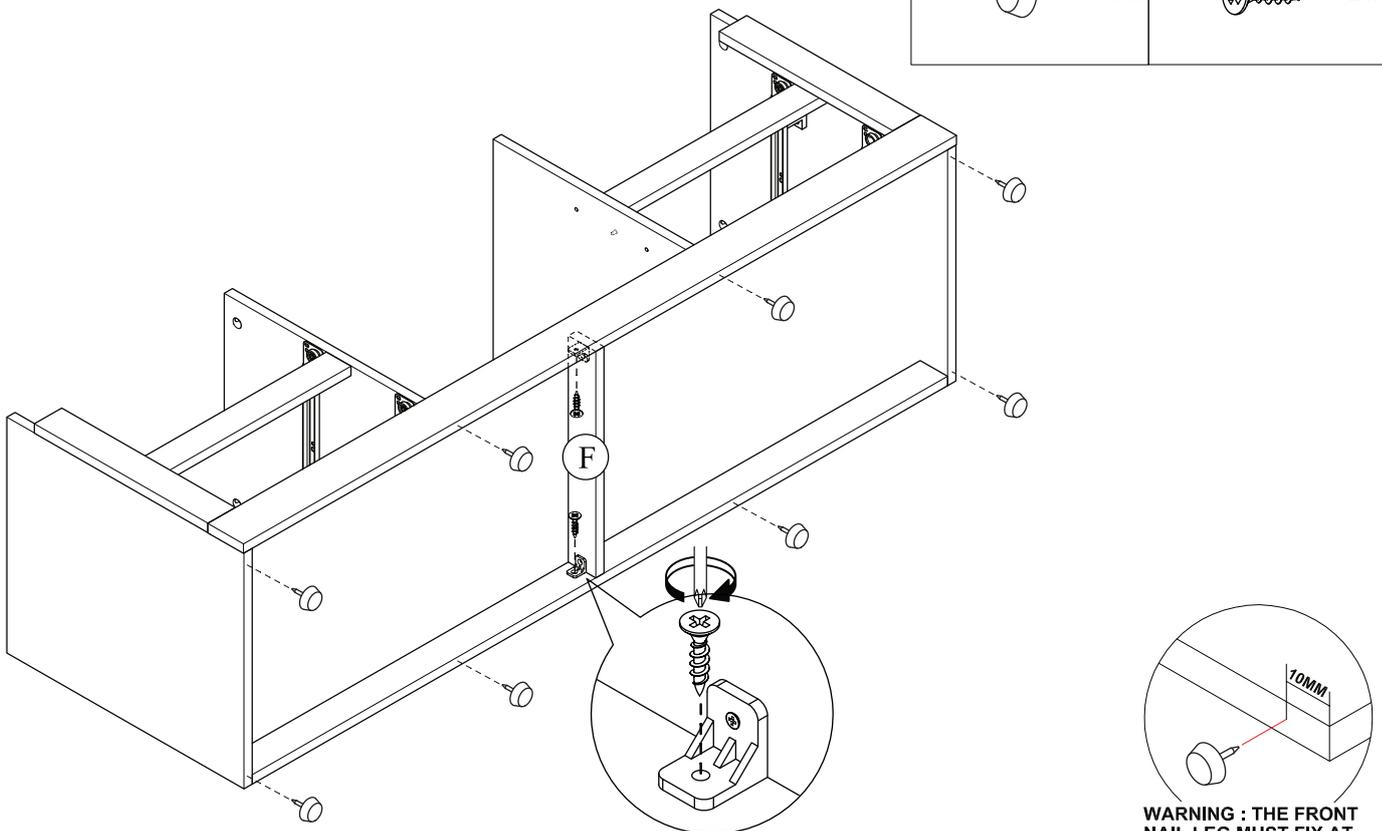
WARNING : THE FRONT NAIL LEG MUST FIX AT 10MM FROM FRONT.
